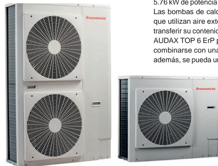
5.76 kW de potencia de calefacción y 7.04 kW de potencia de refrigeración. Las bombas de calor aire-agua AUDAX TOP son aparatos monobloque que utilizan aire exterior como fuente de calor parcialmente renovable al transferir su contenido de energía térmica al sistema de calefacción central. AUDAX TOP 6 ErP puede instalarse en una configuración independiente o combinarse con una caldera que funcione como un sistema integrado o, además, se pueda unir en instalaciones en cascada.
